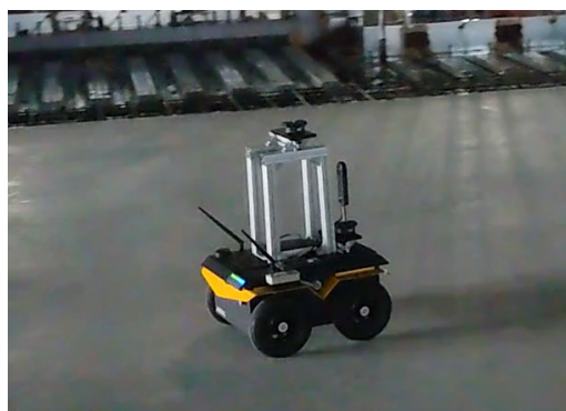
遠隔操縦ソリューション検証に活用している CLEARPATH ROBOTICS 社製 UGV JACKAL
